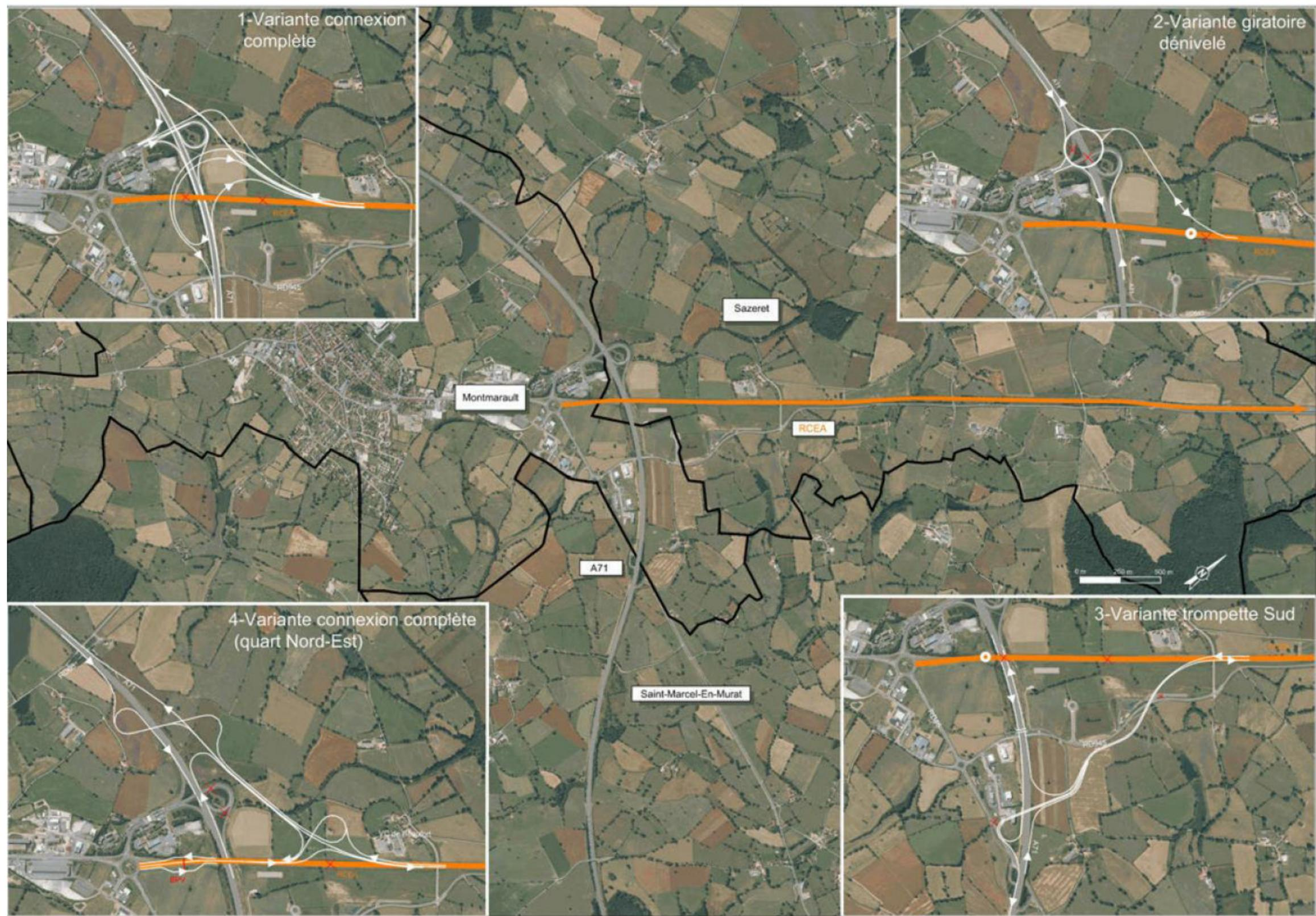
Figure 4 : Plan des variantes d'aménagement du nœud de Montmarault (source : Dossier d'enquête d'utilité publique de la mise à 2x2 voies de la RCEA)
