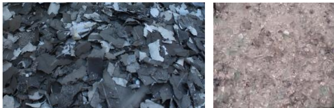
Figure 112 : Fragments de silicium et granulés de verre (source : PVCycle, 2015)
