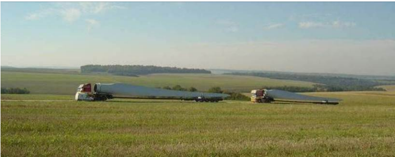
Figure 8 : Exemple de transport de pale par camion
