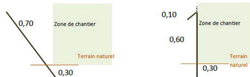
Figure 19 : Principe et caractéristiques des clôtures contre l'intrusion des amphibiens
