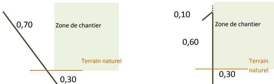
**Figure 7. Principe et caractéristiques des clôtures contre l'intrusion des amphibiens.**
