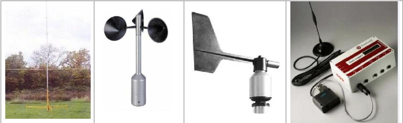
Nous utilisons un anémomètre à coupelles « first class » adapté aux mesures de vents horizontaux. Nos anémomètres optico-électroniques sont accompagnés d'un certificat de calibration, correspondant aux standards internationaux (Certifié selon IEC 61400-12-1 / MEASNET).
