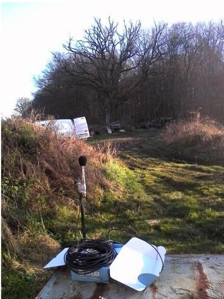
Emplacement du microphone pour la mesure au point n°5
