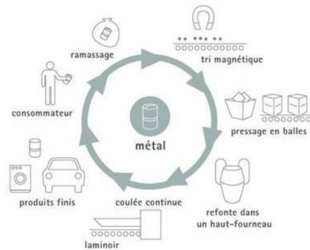
Figure 21 : Cycle de recyclage des structure porteuses (Source : QUADRAN)
