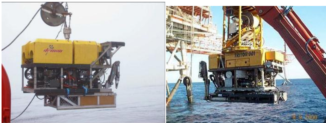
Exemples de ROV de travail, équipés de manipulateurs.
