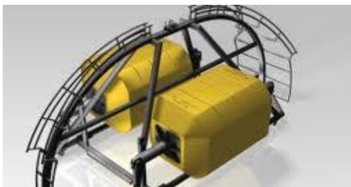
Flottaisons pour arche de riser
