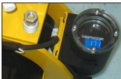
Mesure de contrainte sur riser
