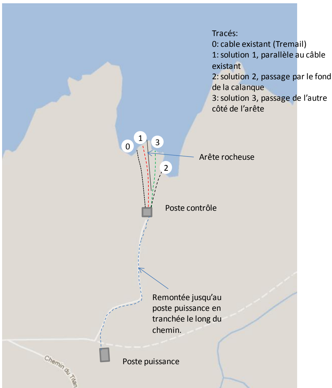
Figure 3 - Différents scénarii pour l'atterrage du câble
