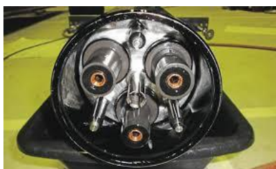
Connecteur de puissance « Powermate » et son outil de mise en place
