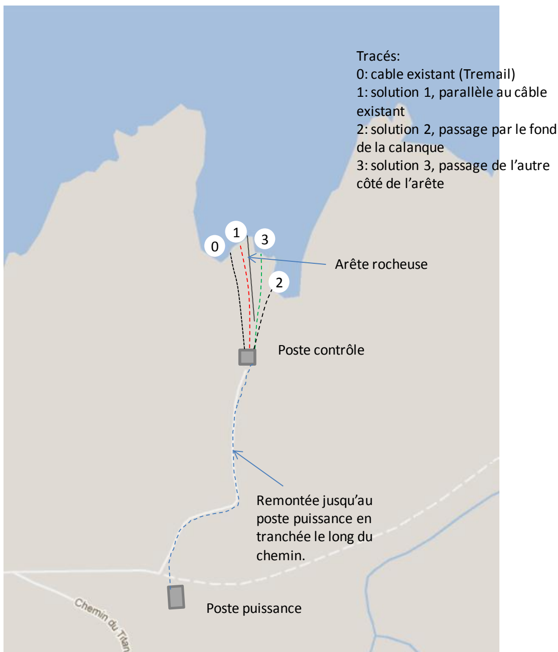
Figure 5 – différents scénarii pour l'atterrage du câble
