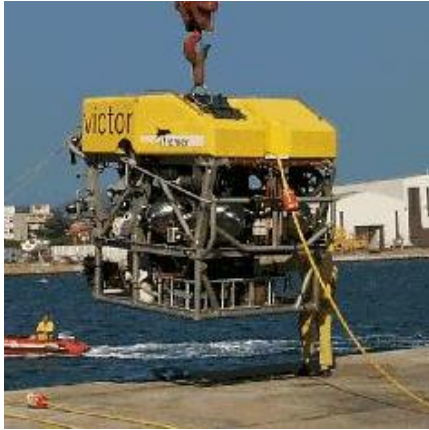
ROV scientifique : VICTOR de l'Ifremer ROV de travail équipé d'une disqueuse
