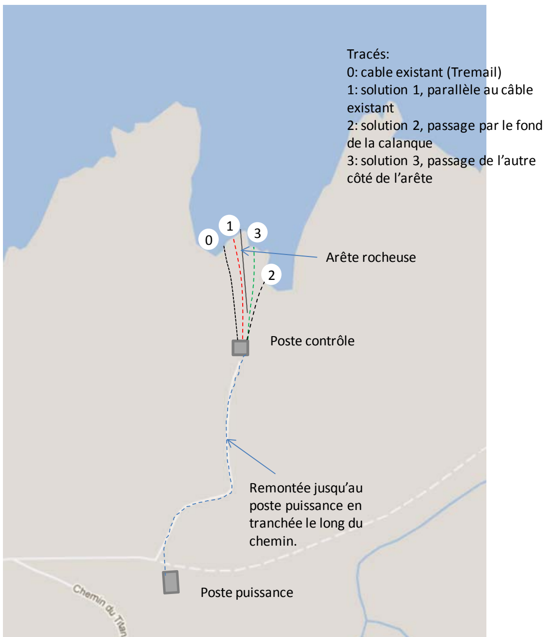
Figure 5 - Esquisse des solutions d'implantation du câble du projet d'Abyssea dans la partie terrestre
