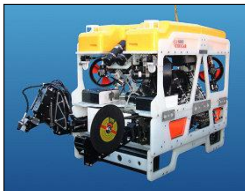
ROV scientifique : VICTOR de l'Ifremer ROV de travail équipé d'une disqueuse
