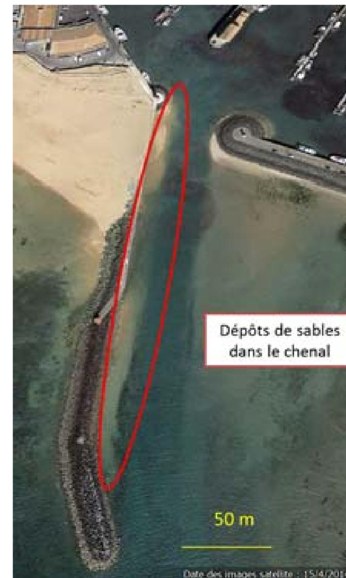
**Figure 52 – Accumulations sableuses dans le chenal**
