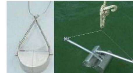
**Figure 72 – Illustration de la benne de type Van Veen et de son armement avant d'être envoyée sous l'eau sur le fond marin**
