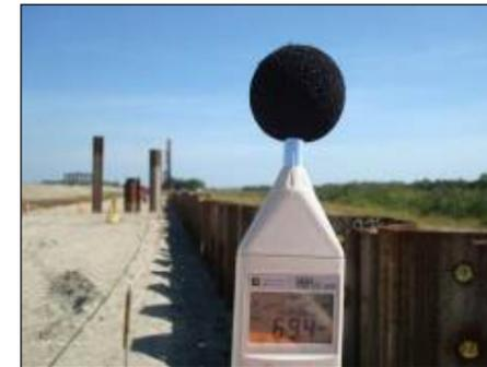
**Photo 6 - Exemple de campagne de mesures de bruit sur chantier de battage**
