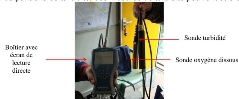
**Photo 1 - Exemple de sonde multiparamètres Neotek pouvant être utilisée pour les mesures de turbidité in situ**
