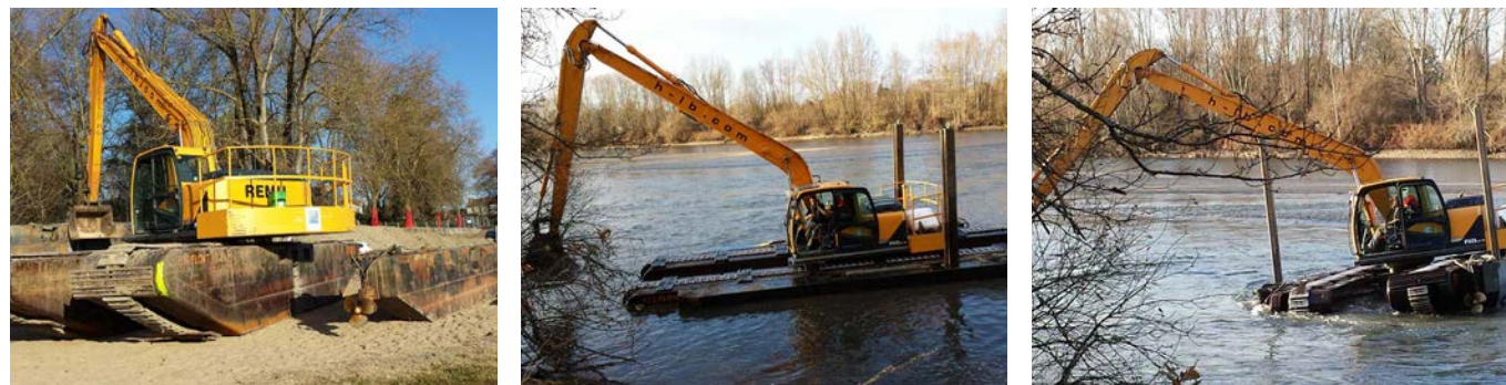
Figure 25 Illustration du matériel (pelle amphibie) qu'il est prévu d'utiliser pour le curage de la prise d'eau (Source : Ville de Vichy)
