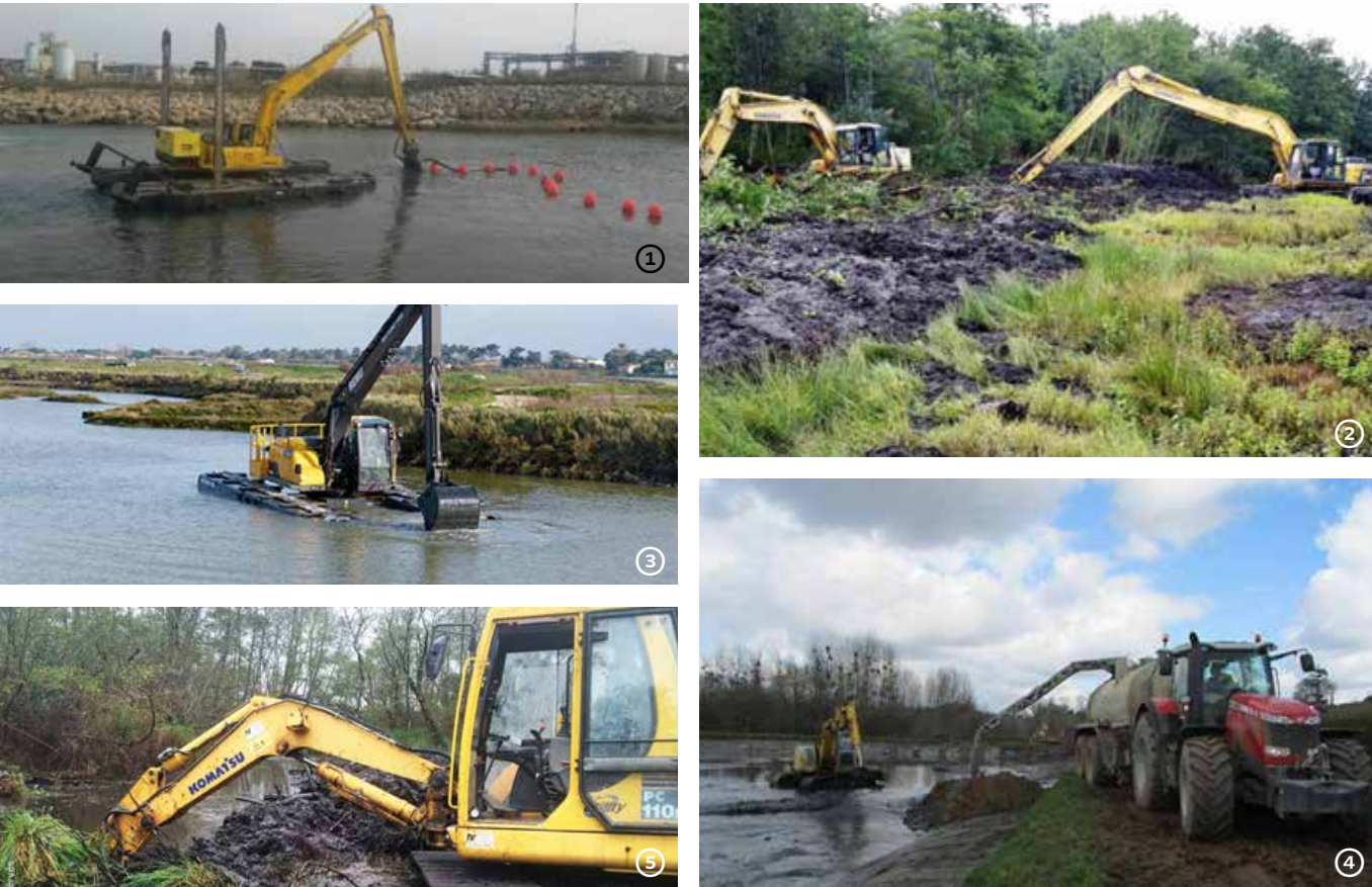
Figure 27 Illustration des engins envisagés pour la réalisation du curage (1) big float - (2) big float et pelle - (3) pelle amphibie - (4) pelleuse à chenilles - (5) pelleuse à chenilles (Source : Ville de Vichy).
