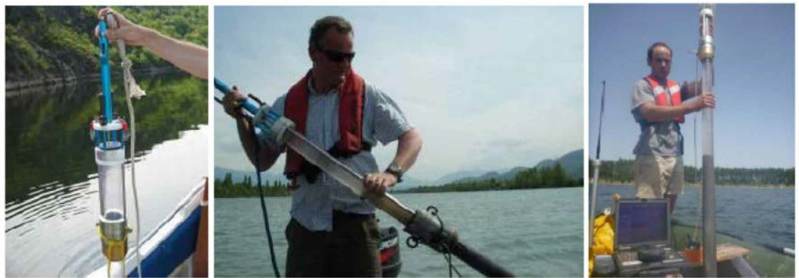
PHOTOGRAPHIES DU CAROTTIER A MAIN UWITEC
