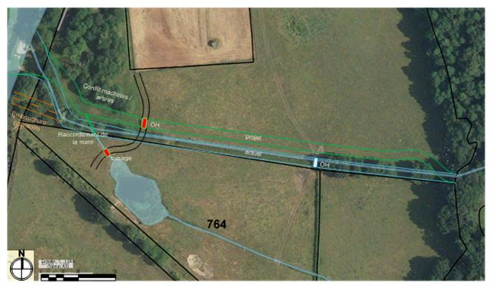
Figure n°11 : Emprise des travaux d'étanchéification du bief amont
