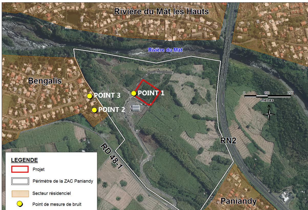
**Planche 72 : Plan de situation des zones à émergence et des points de mesures de bruit**
