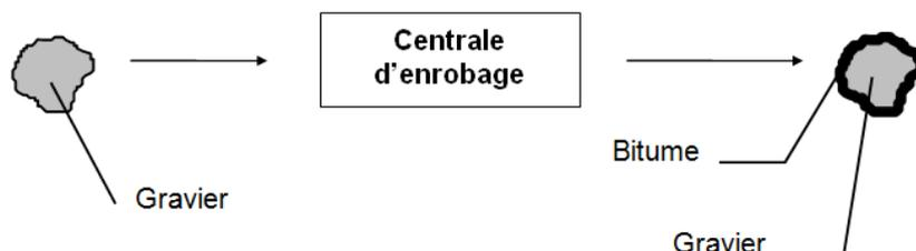
**Planche 7 : Principe de la fabrication d'un enrobé hydrocarboné (bitume)**
