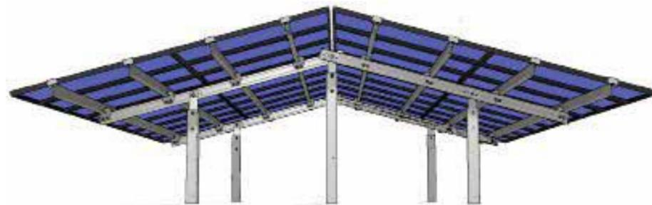
Figure 4 : Disposition des rangées de panneaux photovoltaïques
