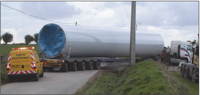
Transport d'une section de mât
