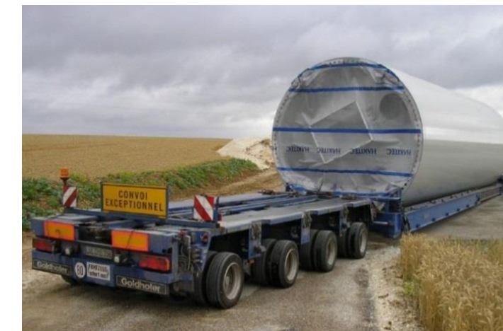
Photo 6 : Transport d'une section de tour d'une éolienne sur site
