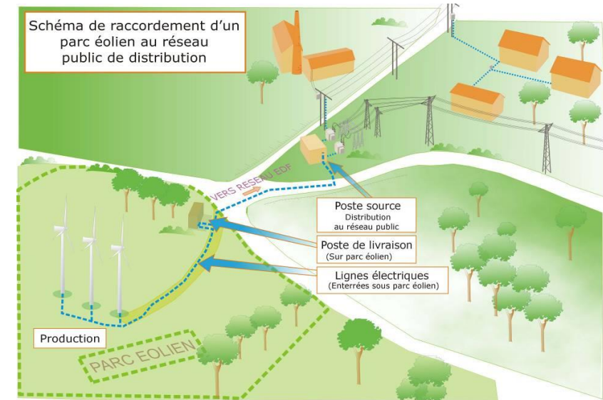
Figure 16 : Composants du parc éolien
