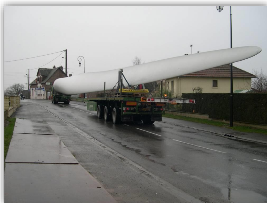
Photo 49 : Camion de transport des pales d'une éolienne
