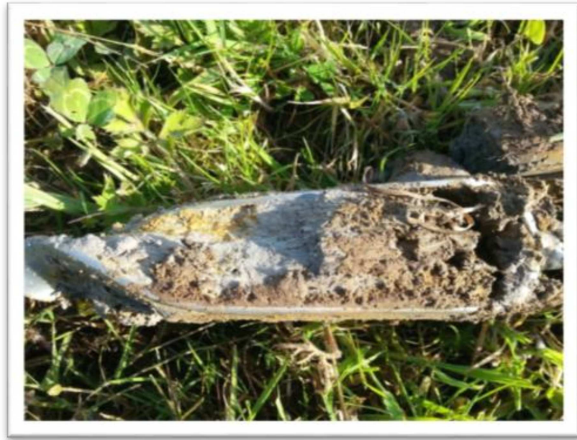
Figure 15 : Exemples de carotte avec des traits réductiques
