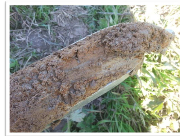
Figure 14 : Exemples de carotte avec des traits rédoxiques
