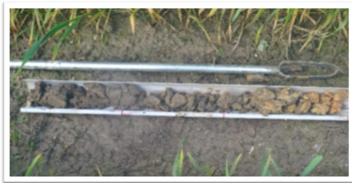
Figure 12 : Exemple de carottage sur une profondeur de 120 cm
