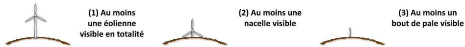
Figure 85 : Les différentes classes de visibilité en fonction de la portion d'éolienne visible
