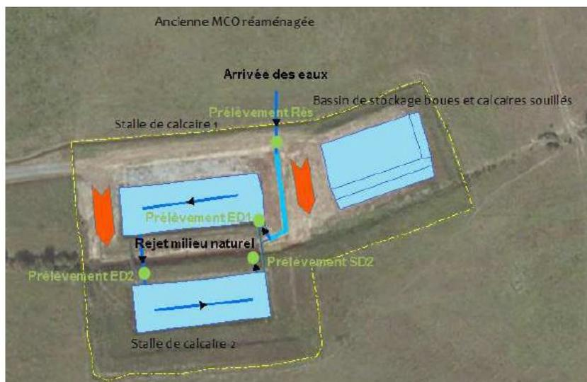
Figure 29 : Fonctionnement des bassins de traitement des eaux d'exhaure de l'ancienne mine uranifère (source : Orano, 2013)
