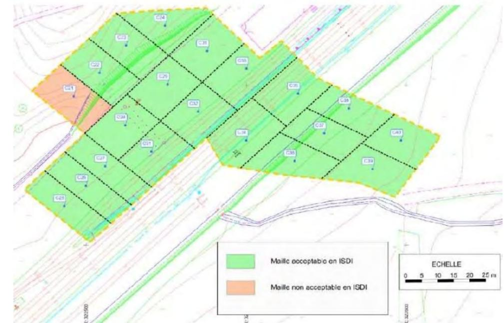
**Fig. 99.** Cartographie des anomalies dans les sols à hauteur du passage souterrain du PEM (à gauche) et du pont-rail (à droite) – (source : SNCF Réseau, septembre 2017)
