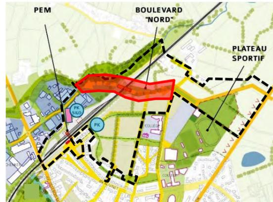
Les travaux générés pour la réalisation du prolongement du boulevard urbain impliquent 20 000 m<sup>3</sup> de déblais, en raison essentiellement de l'impératif passage sous les voies ferrées par l'intermédiaire du pont-rail.
