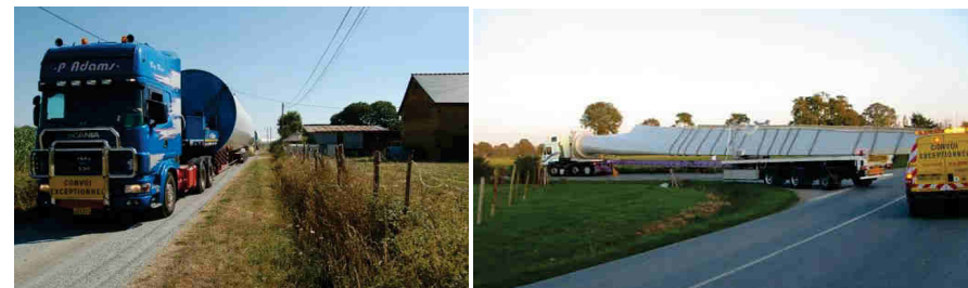
Photo 62 : Le transport des éléments d'une éolienne
