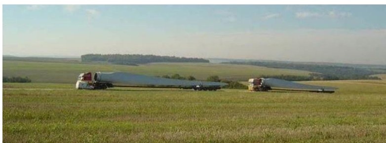
Photo 6 : Exemple de transport de pale par camion
