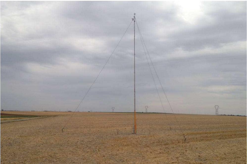
Figure 78 : Mât de mesure de vent (source : Orféa Acoustique, 2015)
