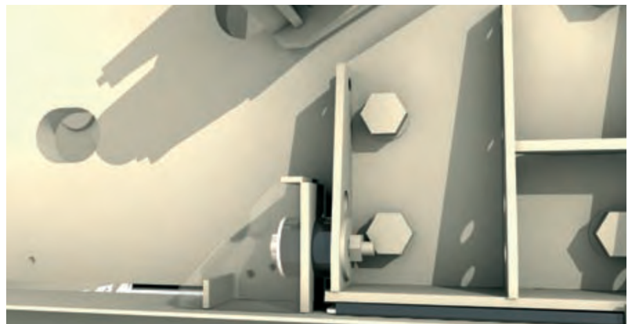
Des amortisseurs et butoirs spéciaux en caoutchouc permettent au concasseur de se déplacer verticalement et longitudinalement tout en empêchant l'usure et les dommages consécutifs sur la fondation du concasseur.
