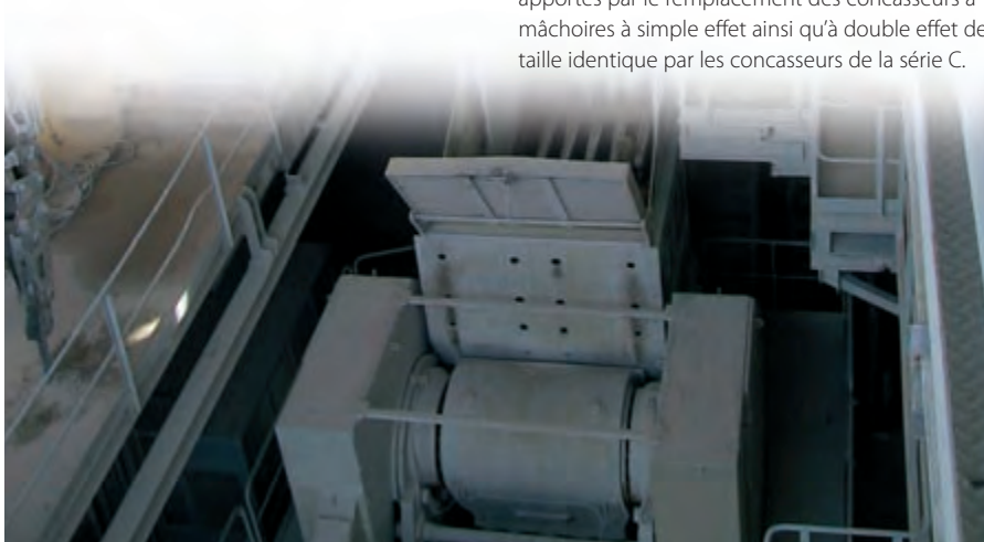
Un C200 remplaçant un concasseur à mâchoires à double effet. La capacité de l'installation a été augmentée sans nécessiter la modification des fondations.
