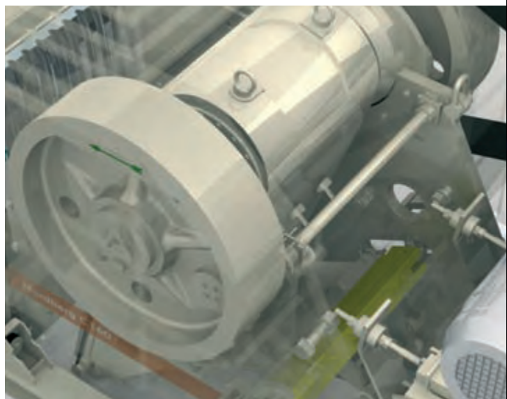
La bielle, de conception robuste, assure une fiabilité supérieure même dans les conditions de concassage les plus difficiles.
