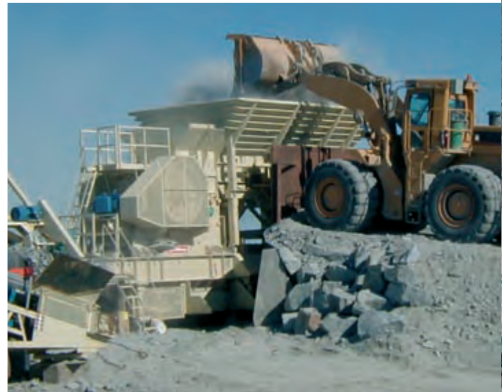
Concassage mobile avec le NW125.
