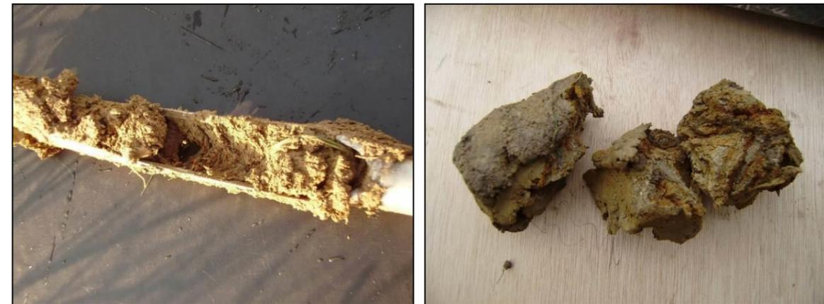
**Figure 10 : Illustrations de sondages à la tarière réalisés avec la présence de trace d'oxydo-réduction permettant d'identifier des sols hydromorphes (photos non prises sur site)**
