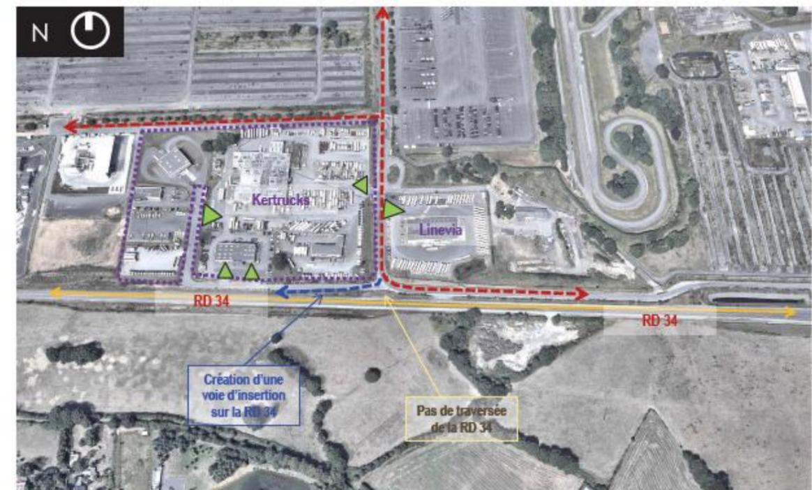
Accès sud - principe de voie d'insertion sur la D34
