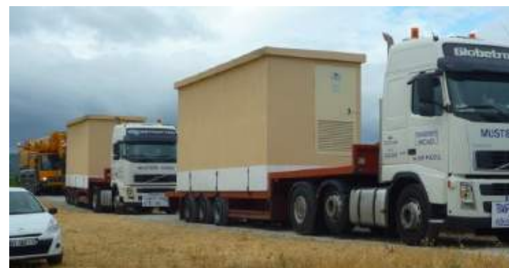
Convoi exceptionnel : Transport des locaux techniques
