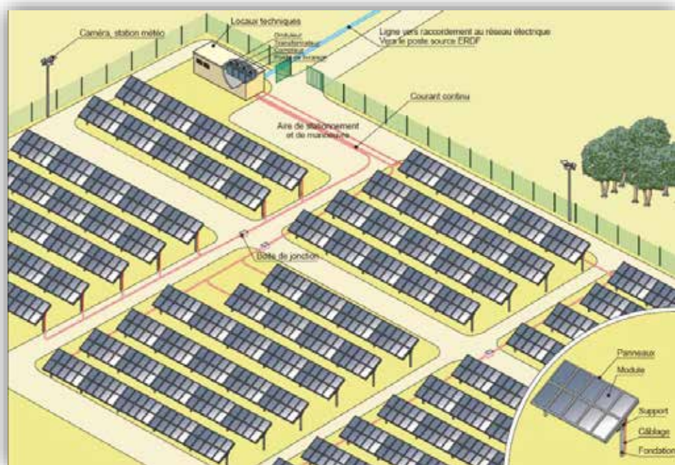
Figure 90 : Principe d'implantation d'une centrale solaire (source : Guide méthodologique de l'étude d'impact d'une centrale PV au sol, 2011)
