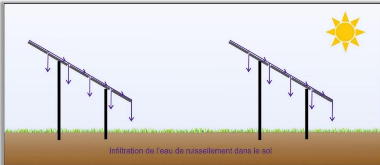
Figure 120 : Effet des panneaux solaire sur l'écoulement des eaux pluviales – Source : Sciences Environnement
