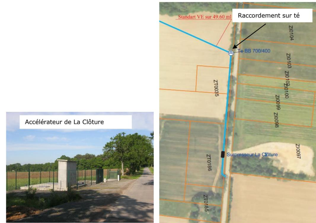
Figure 1-1 : Localisation du raccordement sur la conduite existante
