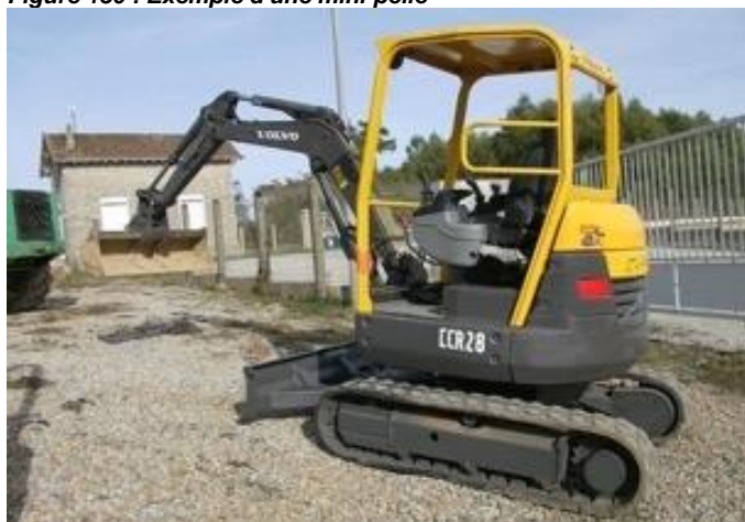
Figure 130 : Exemple d'une mini-pelle
