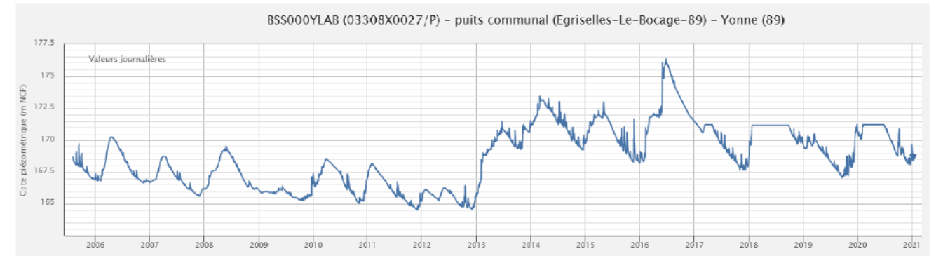
Figure 21 : Chroniques piézométriques disponibles pour l'ouvrage BSS000YLAB (Source : Banque ADES) Cependant, nous constatons sur cette chronique la formation de paliers à partir de mars 2017 qui empêchent le niveau piézométrique de passer au-delà de 171,22 m NGF. Ce phénomène n'est pas naturel.
