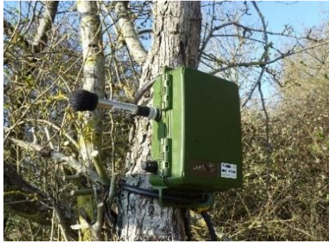
Photo 15 : Détecteur d'ultrasons utilisés lors de l'étude
