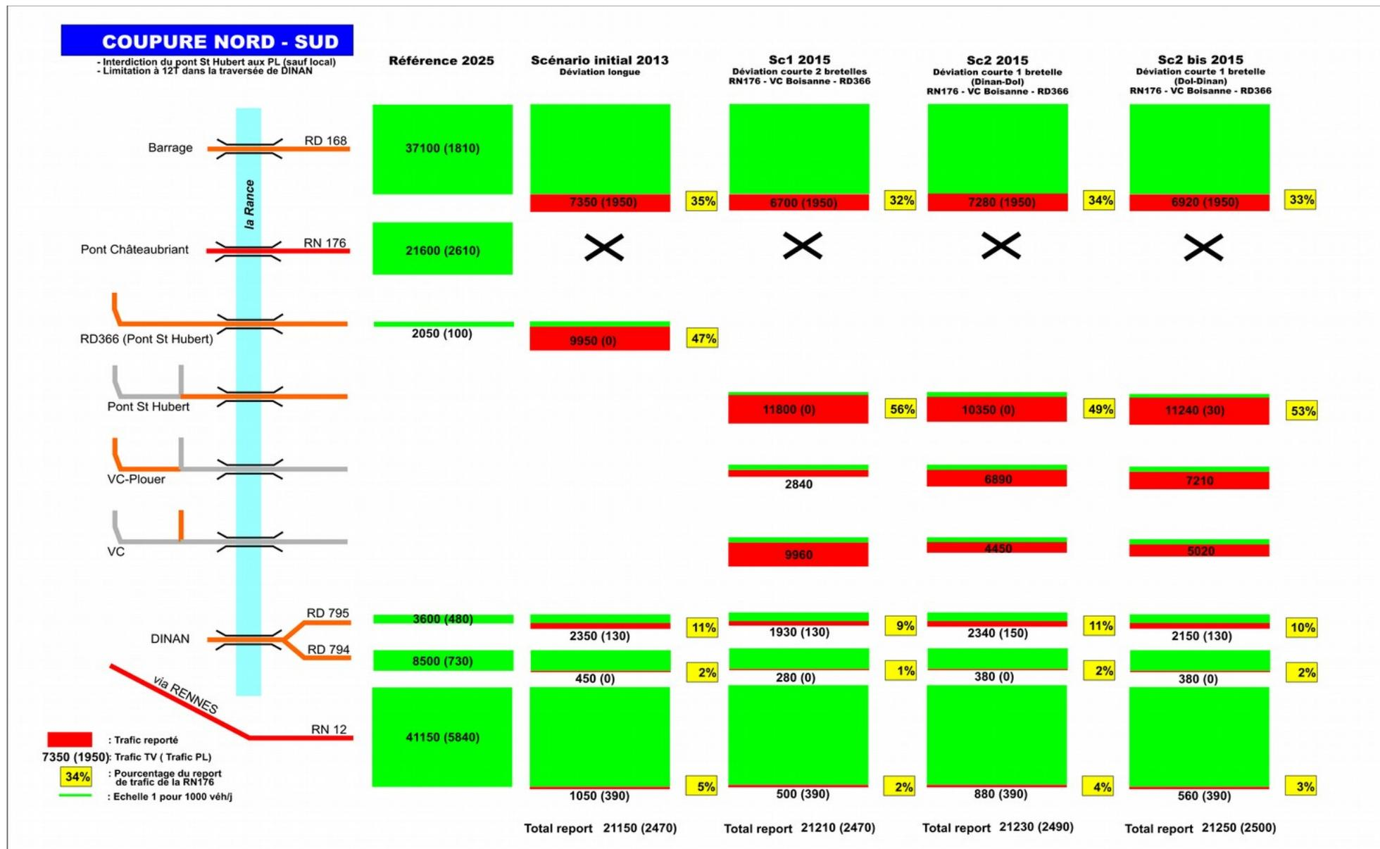
Figure 11 : Répartition des flux (2025)- coupure Nord Sud (interdiction du pont st Hubert au PL (sauf Local), traversée Dinan limitée à 12 T (Sc1-Sc2)
