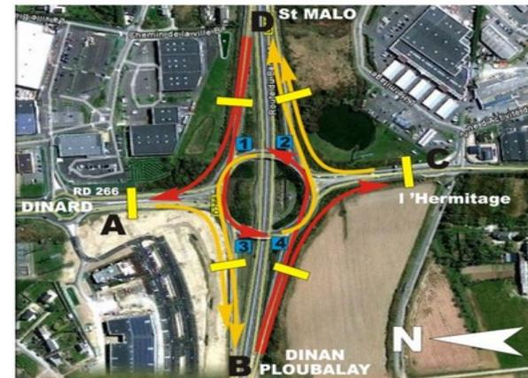
L'hypothèse sera prise, qu'il n'y a pas de demi tour. Les véhicules sur l'anneau viendront d'une entrée de la RD266, ceux allant sur l'anneau iront sur une sortie de la RD266. Les mouvements « tout droit » des RD 266 et RD 168 seront calculés par différence avec les compteurs automatiques et les comptages manuels.
