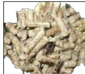
Le bois granulé peut être livré en sacs (poêles à granulés) ou en vrac par camion souffleur (chaudières automatiques).
