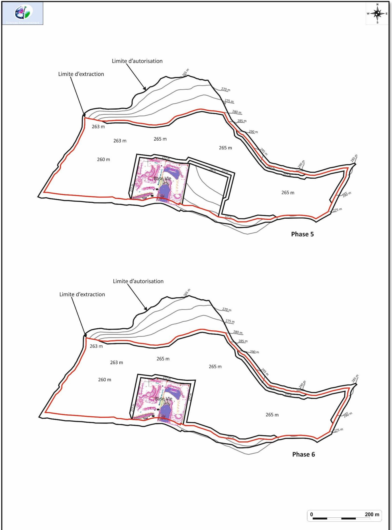
Figure 13 : Phasage de l'extraction - Phases 5 et 6
