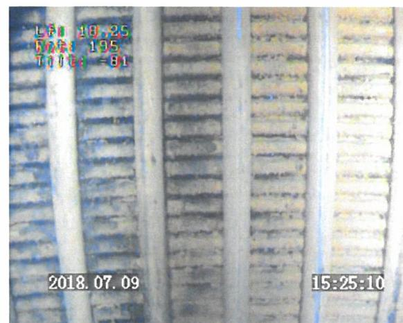
Prof 18.25 m : tube inox crépiné à fils enroulés / fentes partiellement colmaté
