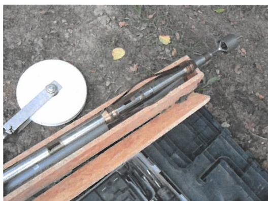
D'une manière générale, les enregistrements de la température, de la conductivité et de la vitesse de rotation de l'hélice du micromoulinet se sont déroulés dans des conditions normales sans non-conformités apparentes. L'hélice du micromoulinet s'est révélée peu perturbée par les frottements de la sonde sur les parois.
