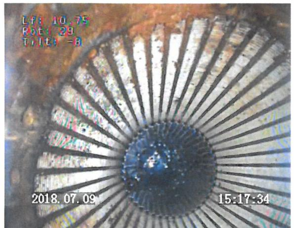
Prof 10.75 m : vue axiale sur la surface piézométrique/ tube inox crépiné à fils enroulés
