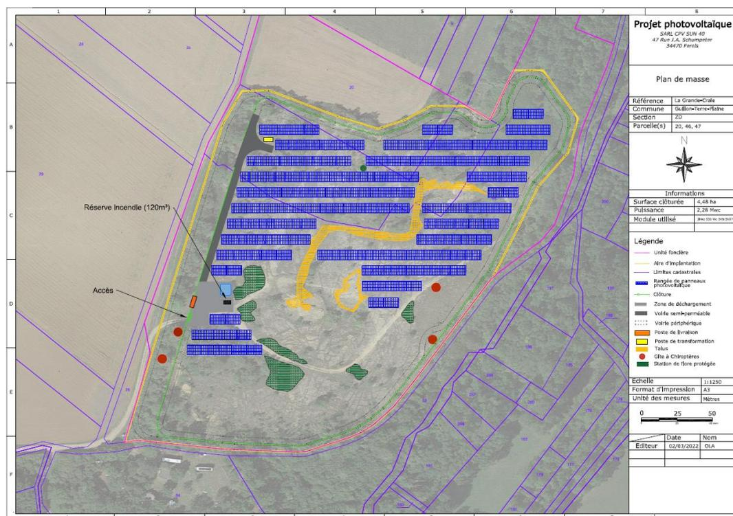
Figure 7 : Plan d'implantation de la seconde variante (Scénario 5)
