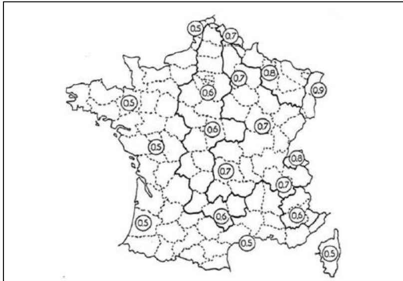
Figure 7: Carte de profondeur de mise hors gel (figure O.4.4.2 de la norme NF P 94 - 261)
