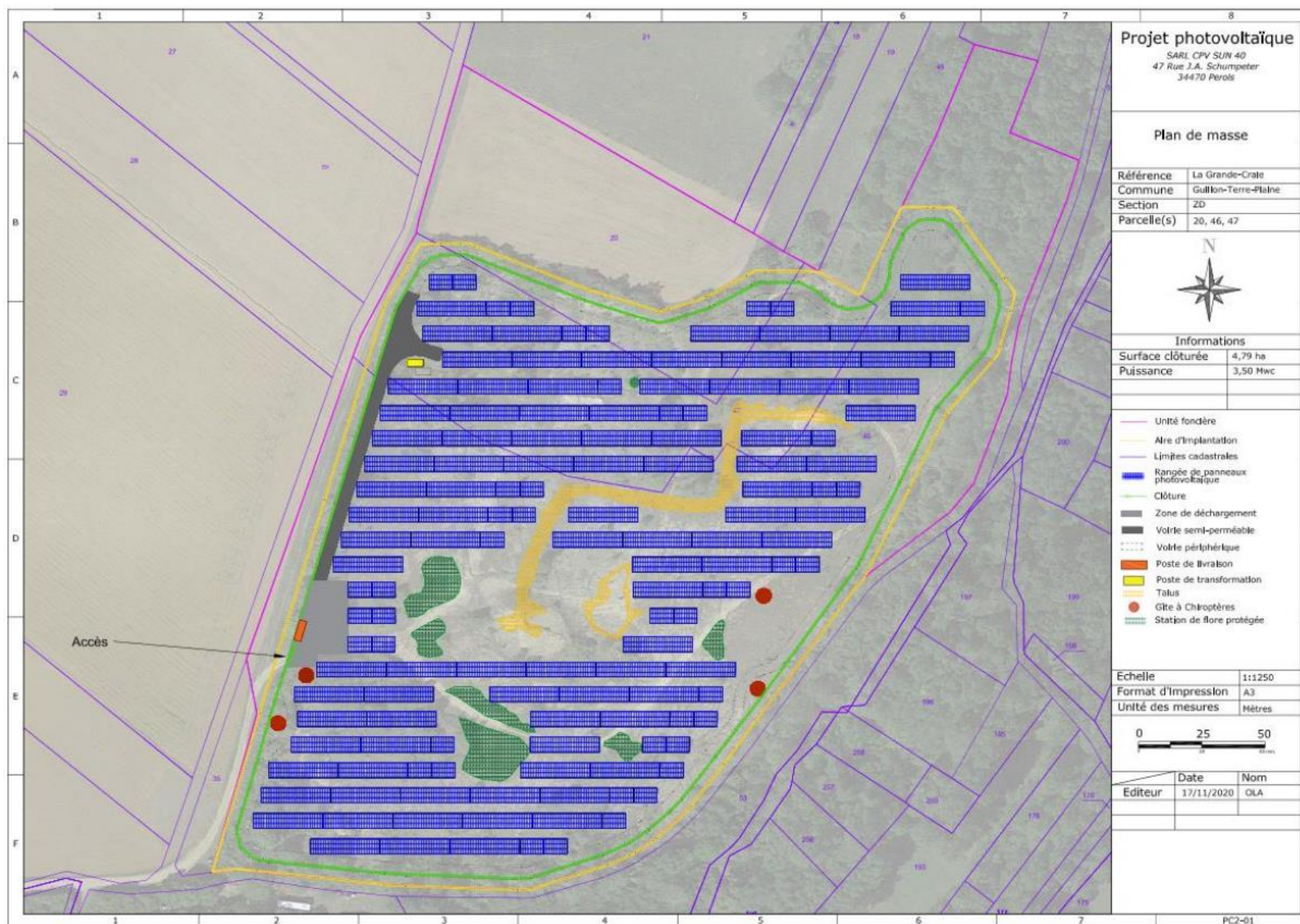
Figure 17 : Plan de masse du projet photovoltaïque de la zone 1 – Grande Craie (EDF Renouvelables)
