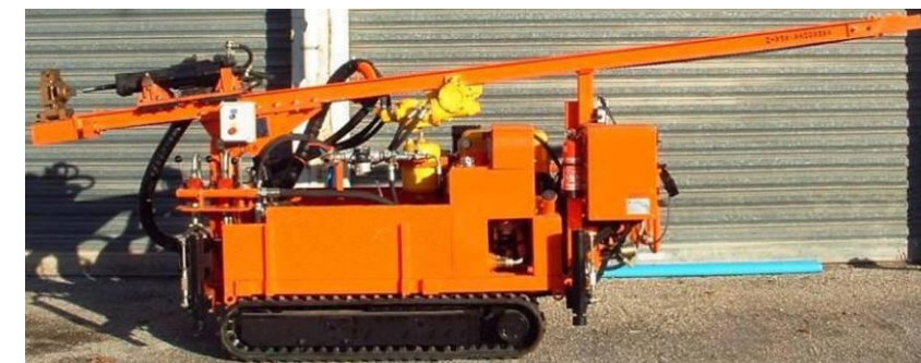
Photo 32 : Sondeuse de type wagon drill hydraulique (Source : FONDASOL)
