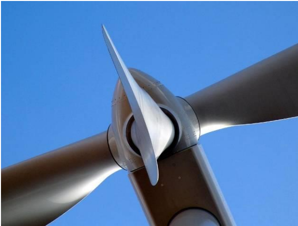
Photo 38 : L'annulation de la portance des pales à vent fort par "mise en drapeau" (Source : Larousse.fr)
