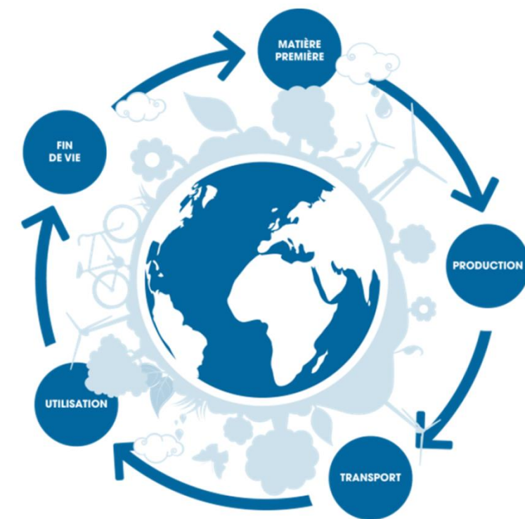
Figure 35 : Etapes prises en compte dans l'analyse du cycle de vie (Source : ADEME, 2015)
