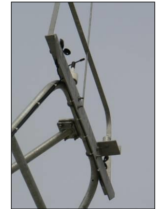
Photo 27 : Exemple d'anémomètre et girouette sur nacelle (Source : The Wind Power)
