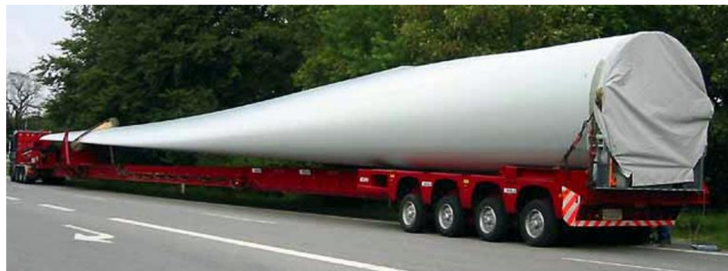
Photo 28 : Exemple de transport de pale par convoi exceptionnel (Source : NICOLAS Industries)
