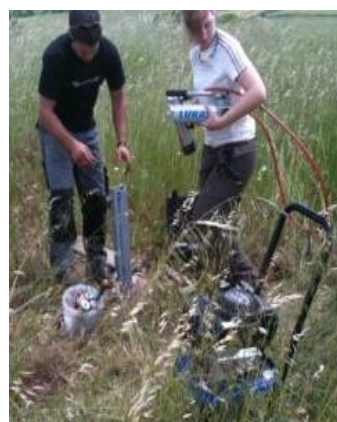
Figure 18. Test de résistance à l'arrachage des pieux
