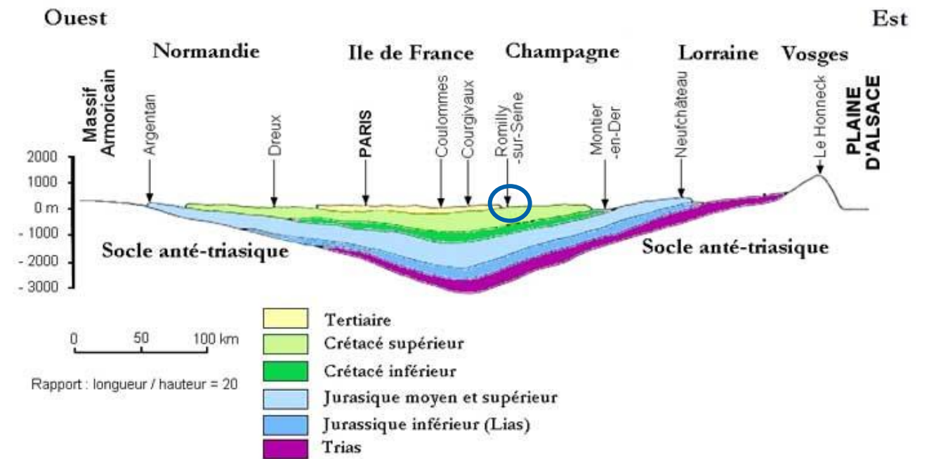
Figure 20 : Coupe schématique du Bassin Parisien entre le Massif Armoricain et la plaine d'Alsace – Cercle bleu : zone d'implantation potentielle (source : Cavelier, Mégnien, Pomerol et Rat, 1980)
