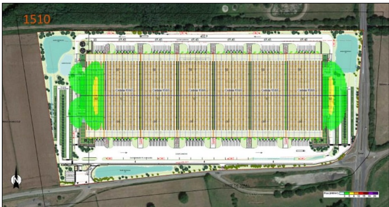
Figure 26 : Cartographie des flux thermiques rayonnés en cas d'incendie des cellules 1 à 8 – palette 1510
