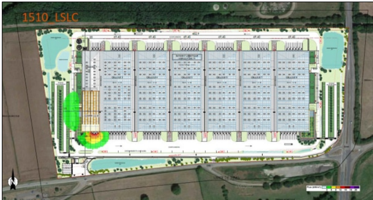
Figure 28 : Cartographie des flux thermiques rayonnés en cas d'incendie de la cellule 2 (liquides combustibles et solides liquéfiables)
