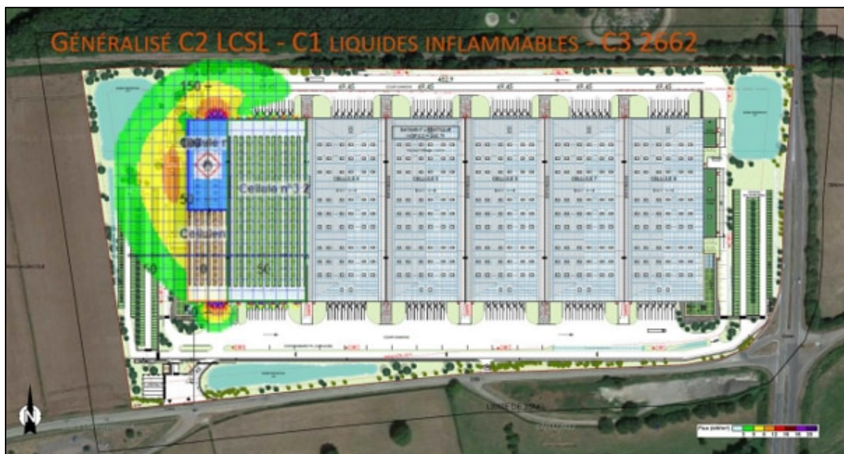
Figure 33 : Cartographie des flux thermiques rayonnés en cas d'incendie généralisé de la cellule 2 (LCSL) aux cellules 1 (liquides inflammables) et 2 (2662)
