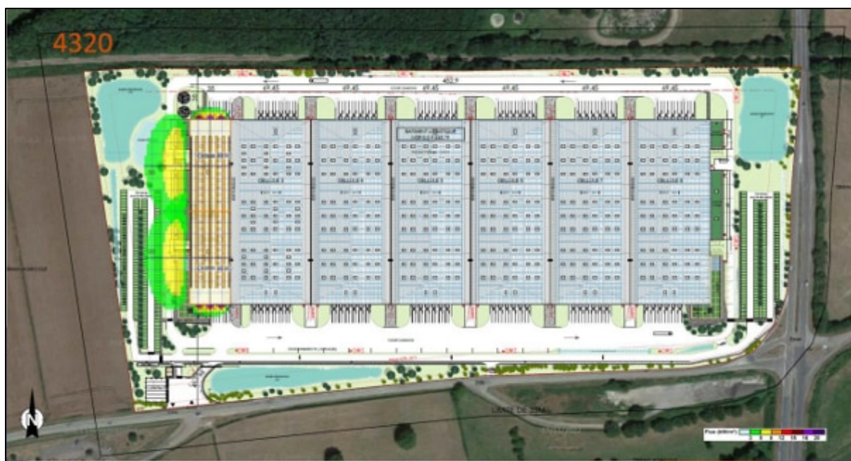
Figure 30 : Cartographie des flux thermiques rayonnés en cas d'incendie des cellules 1 et 2 (Palette 4320)
