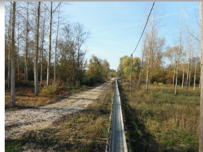
Exemple de bande transporteuse mise en place sur le site d'exploitation de Perthes
