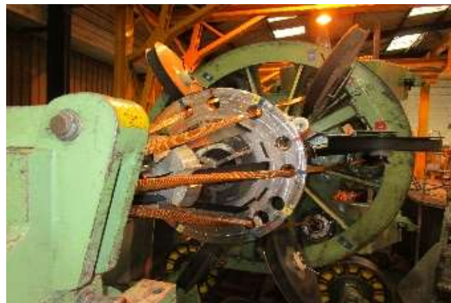
Figure 10 : Ligne de câblage HT et THT en cours de fonctionnement (source : PRYSMIAN)
