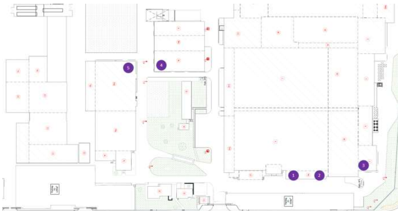
Figure 25 : Localisation des chaudières sur le site de Gron (source : PRYSMIAN)
