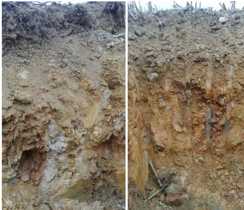
Figure 18 : Vue de détail sur l'horizon S du profil de sol – fosse n°3
