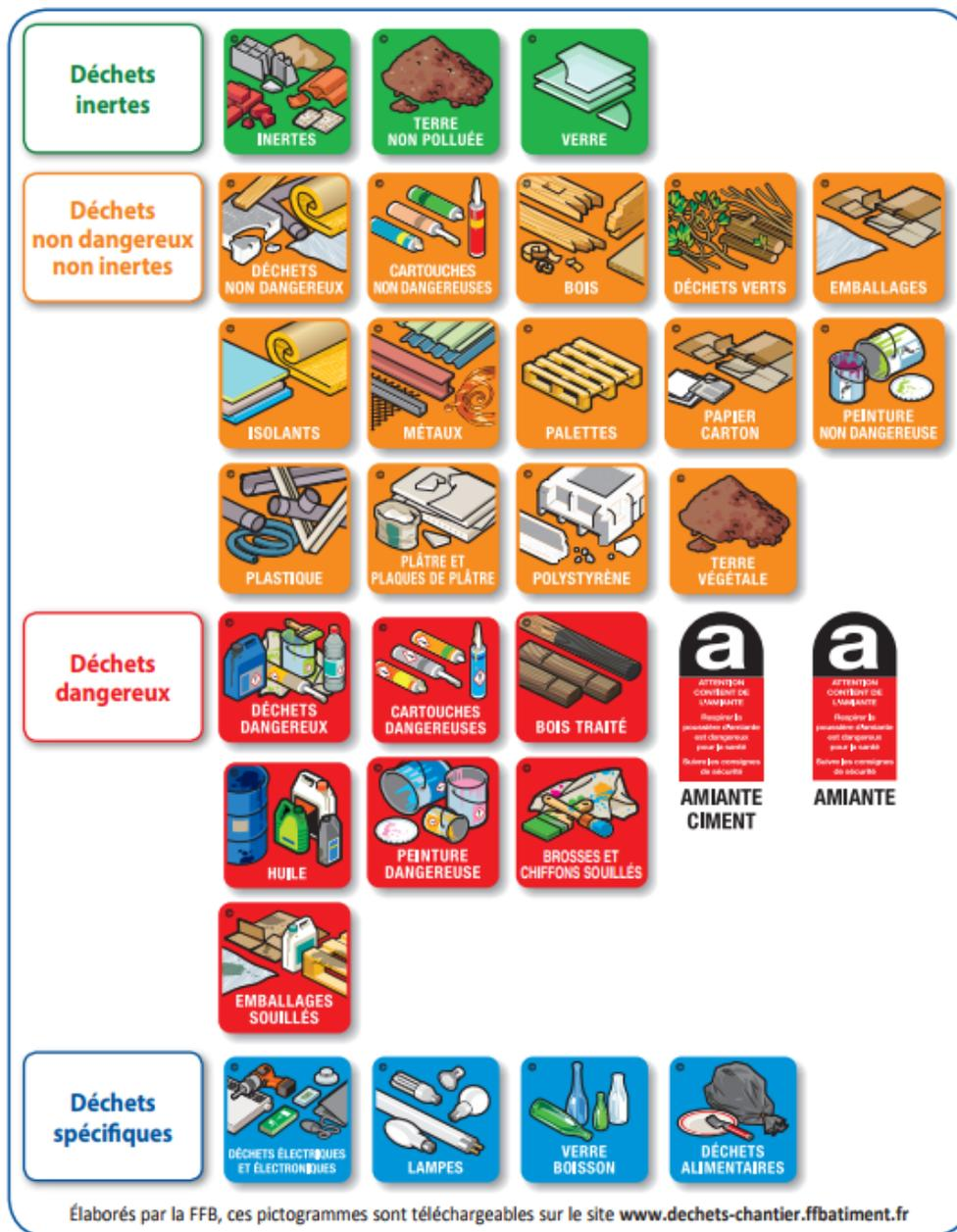
Figure 95 : Catégories de déchets et pictogrammes déchets de chantier (Source : Fédération Française du bâtiment)
