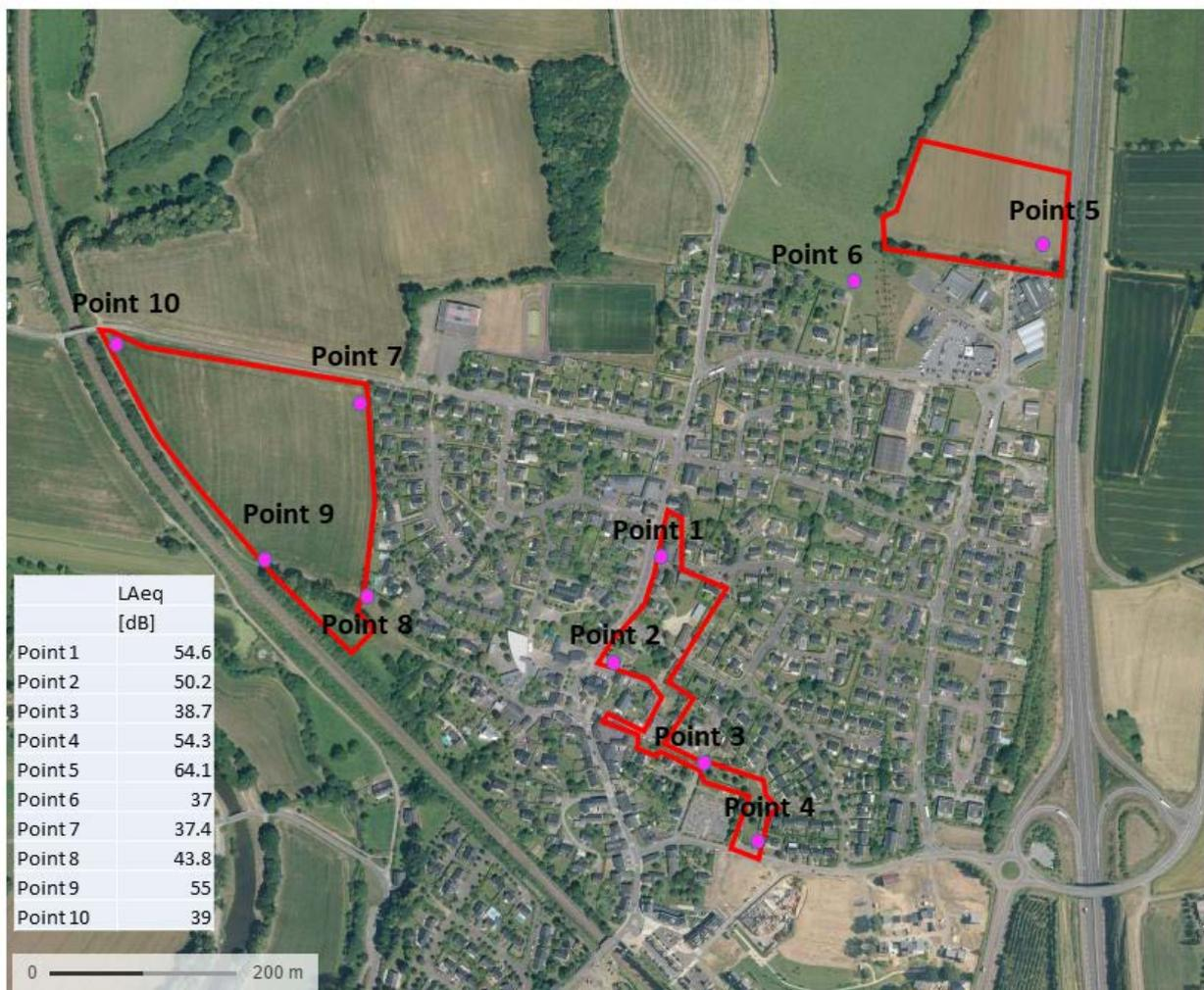
Figure 81 : Localisation des points de mesure de bruit et niveaux de bruit enregistrés
