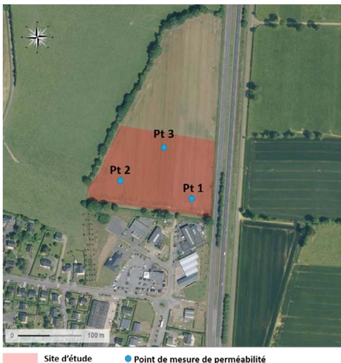
La méthode consiste à réaliser un trou à la tarière de diamètre 150 mm, d'une profondeur d'environ 60 cm et d'y verser de l'eau régulièrement pendant 4 heures afin de saturer le sol en créant un bulbe de saturation (phase d'imbibition). Ensuite une cellule de régulation, reliée à un réservoir d'eau, est placée au fond du trou. Celle-ci régule automatiquement le niveau de l'eau à 15 cm au-dessus du fond. On observe alors sur le réservoir d'eau le volume percolant pendant une durée de 10 minutes.
