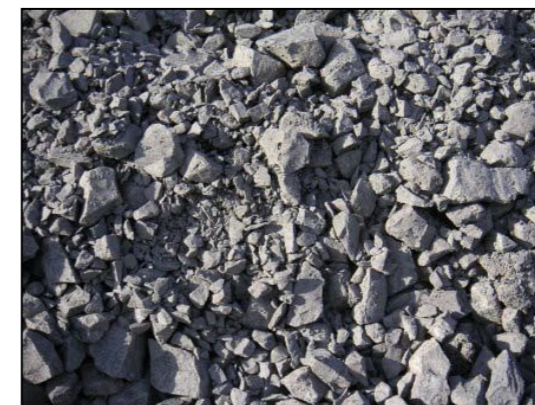
Figure 24 - Exemple de granulats utilisés pour la création ou la reprise des pistes
