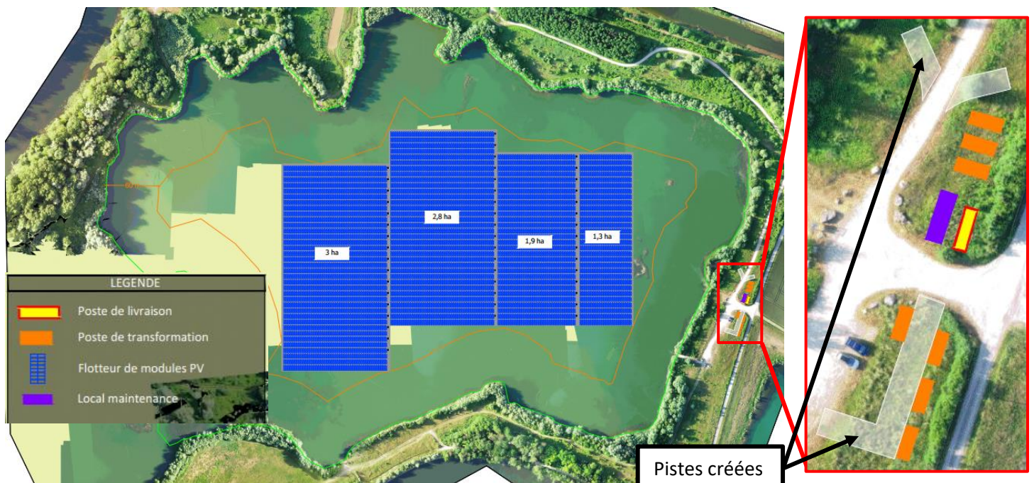
Illustration 2 : Plan schématique de la disposition des infrastructures du projet (Source : Générale du Solaire, 2022)
