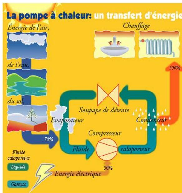
Figure 65 : principe de fonctionnement des pompes à chaleur (source [www.airclim-concept.com](http://www.airclim-concept.com))
