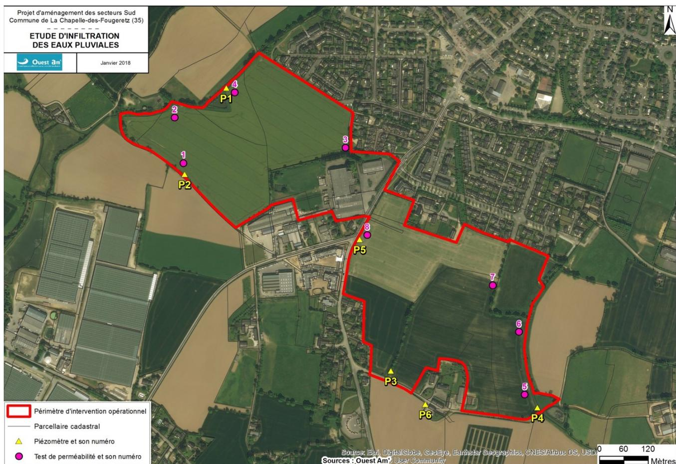
Carte 4 : Emplacement des tests de perméabilité
