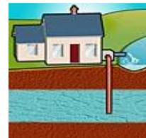
Elle concerne les aquifères peu profonds d'une température inférieure à 30°C, température très basse, qui peut cependant être utilisée pour le chauffage et la climatisation si l'on adjoint une pompe à chaleur.
